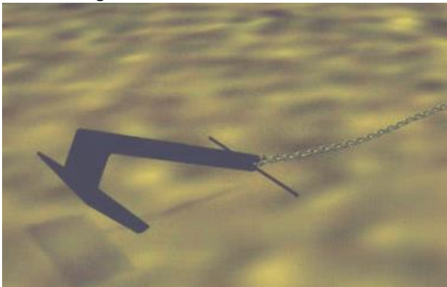
Figur 5: EH ploganker i startfase av strekktest
